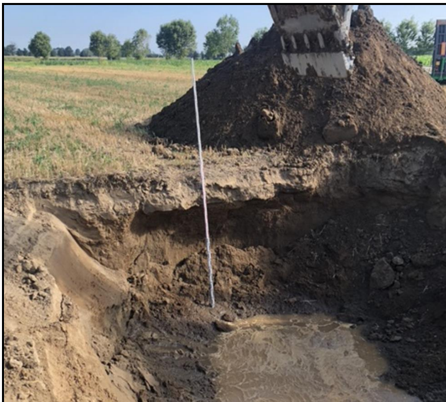
Figura 7 – Sondaggio eseguito con escavatore. Presenza di falda a fondo sondaggio.
